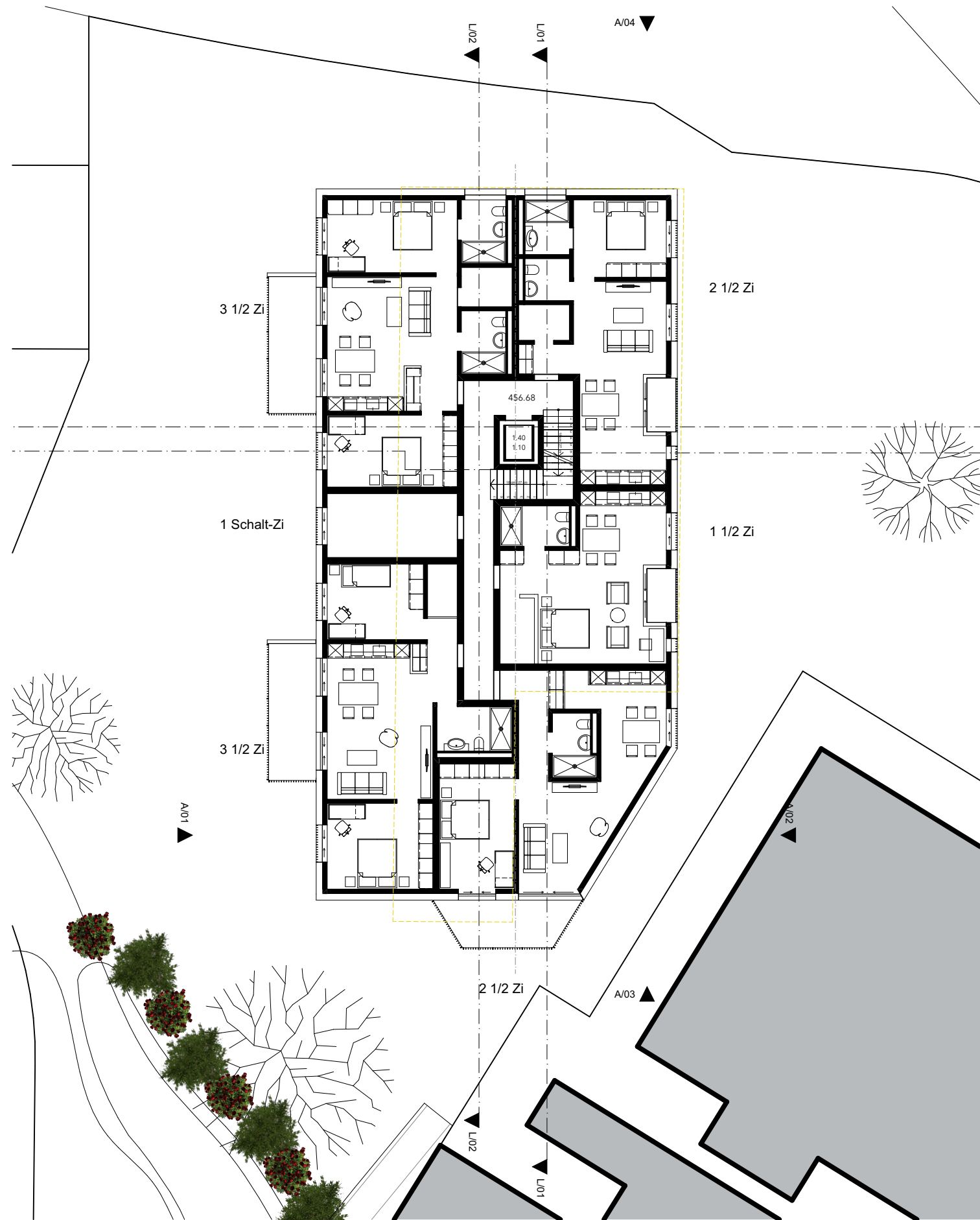
1. Obergeschoss 1:200 / Variante mit Schaltzimmer
